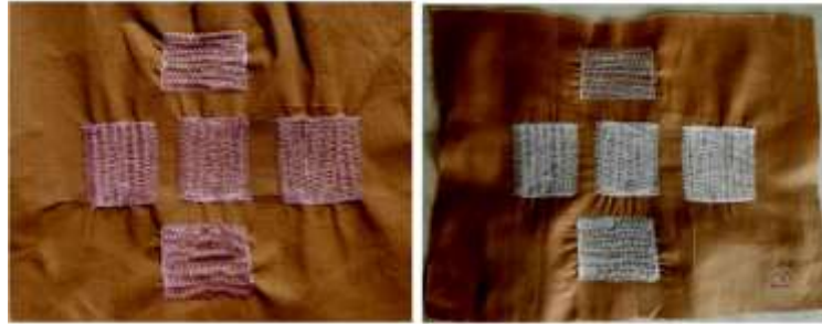
شكل رقم (10) يوضح تأثير أشعة الشمس علي خيط التطريز المعالج بالصبغة الكروموجرافية.
