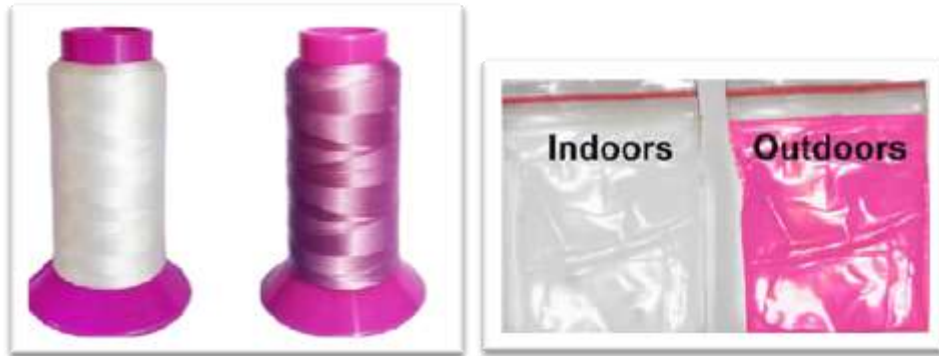
شكل رقم (7) يوضح تأثير ضوء الشمس علي بعض أنواع المواد الفوتوكرومية.
