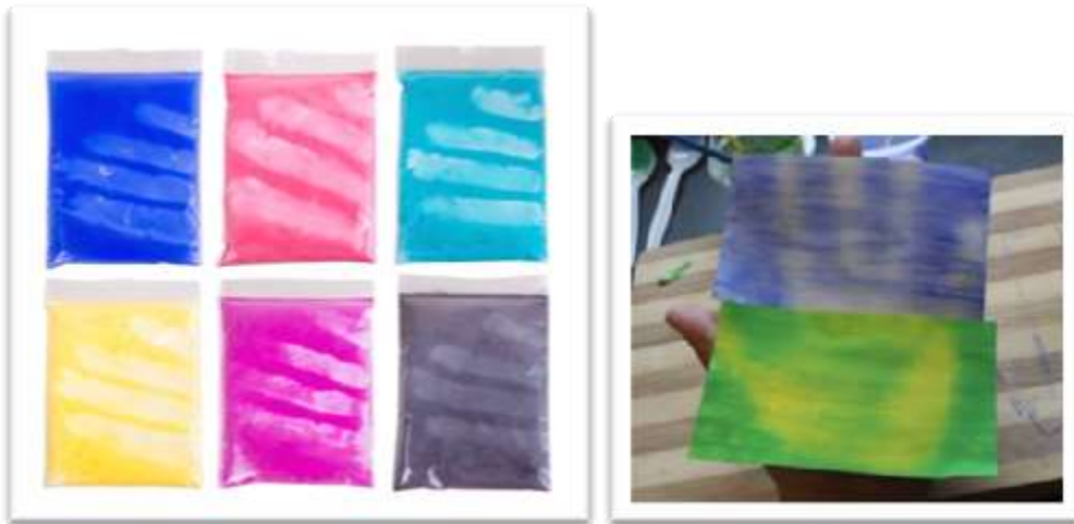
شكل رقم (5) يوضح تأثير درجة حرارة الجسم علي تغير لون الصبغات الكرومحرارية.
